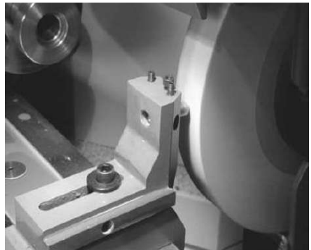
Оправка шлифовального круга на рабочем столе
