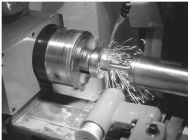
3-х кулачковый патрон (внутреннее шлифование)
