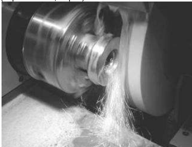
Шлифование буртика (торцевое шлифование)
